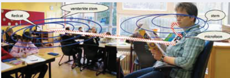
Figuur 1. Het stemgeluid van de leerkracht wordt opgevangen door de leerkrachtmicrofoon en door middel van infrarood techniek (afgebeeld als rood gearceerde pijl) gezonden naar het klassenversterkingsapparaat Redcat, dat achter in de klas staat. Van hieruit wordt het geluid gelijkmatig door de klas verspreid.
